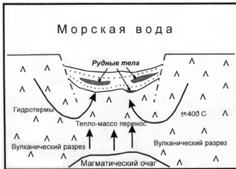
Рис. 10. Простейшая из возможных моделей схема формирования Кварцитогорского месторождения
