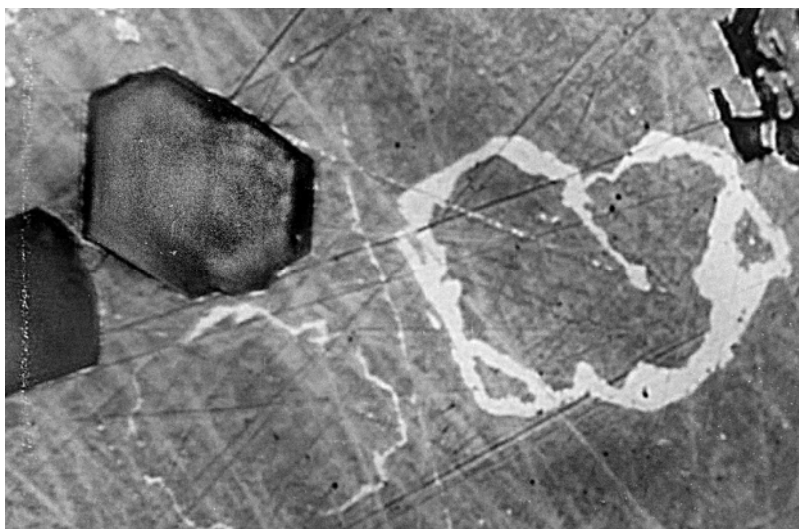
Рисунок 4 – Джезказганит и метакристаллы позднего кварца в борните. Аншлиф, отраженный свет. Ув. 1500, иммерсия
