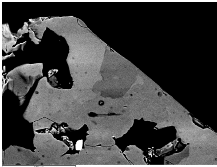
Рисунок 4 – Зональное зерно гагаринита в эпоксидной смоле (черное): тяжелая разновидность минерала (светло-серое), легкая (темно-серое). Микровключения бастнезита-(Ce) (белое). BEI-компо
