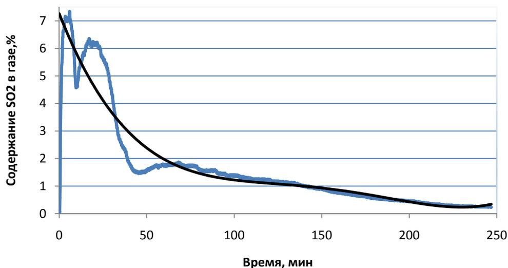
Рисунок 4 – Изменение содержания SO<sub>2</sub> в отходящих газах при окислении коллекторных штейнов воздухом при 800 °С
