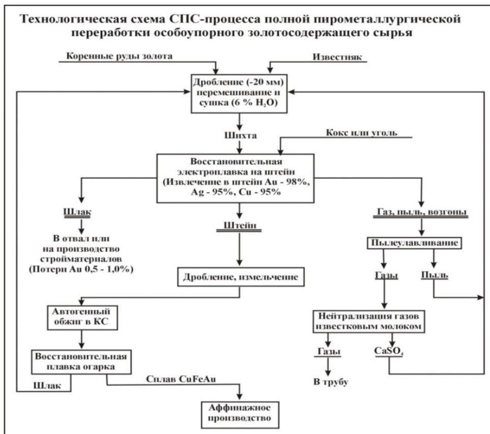
Рисунок 1 – Технологическая схема СПС-процесса пирометаллургической переработки особоупорного золотосодержащего сырья
