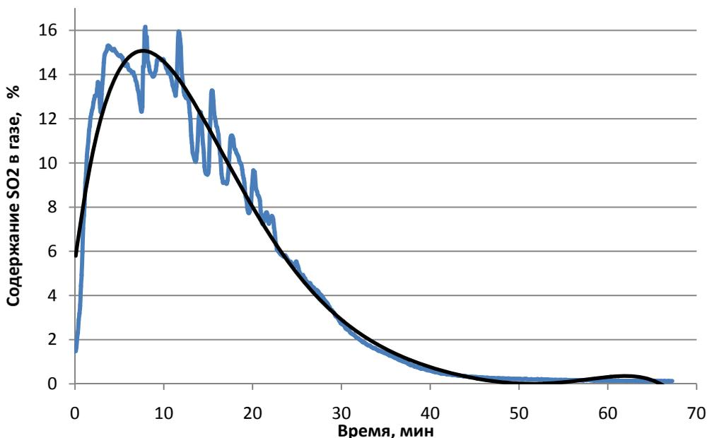
Рисунок 5 – Изменение содержания  $\text{SO}_2$  в газовой фазе при окислении коллекторных штейнов кислородом при 800 °C
