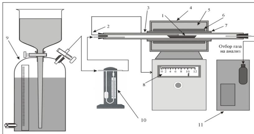
Рисунок 3 – Установка для обжига штейна:
