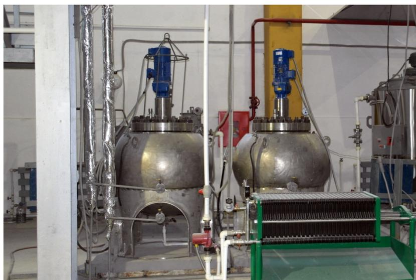
Рисунок 7 – Опытная установка на ОЭМП. Автоклавы объемом 500 литров
