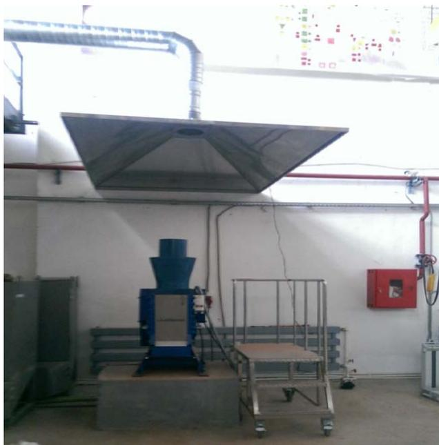
Рисунок 4 – Опытная установка на ОЭМП. Дробилка Laarmann LMFC-250
