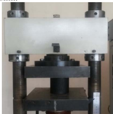
Рисунок 20 – Испытание образца асфальтобетона цилиндрической формы на механическом прессе по схеме сжатия
