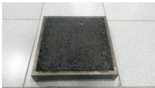
Рисунок 22 – Образец асфальтобетона размером 5x30,5x30,5 см в стальной форме
