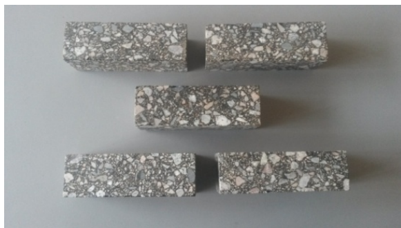
Рисунок 23 – Образцы асфальтобетона размером 5x5x16 см
