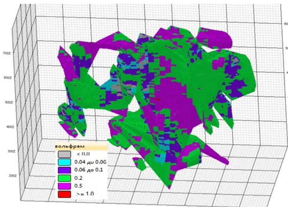
Рисунок 2 – Трехмерная модель месторождения Катпар
