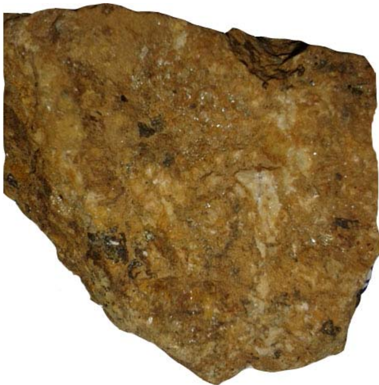
Рисунок 4 – Образец 23. Брекчия железненная с включениями рудных минералов. Карамурунская свита (x2,1)
