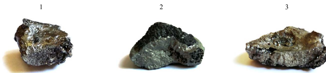
Рисунок 8 – Ферроникель, полученный из Белогорской руды в присутствии 2,5% кокса (1), 5% кокса (2) и 10% кокса (3)
