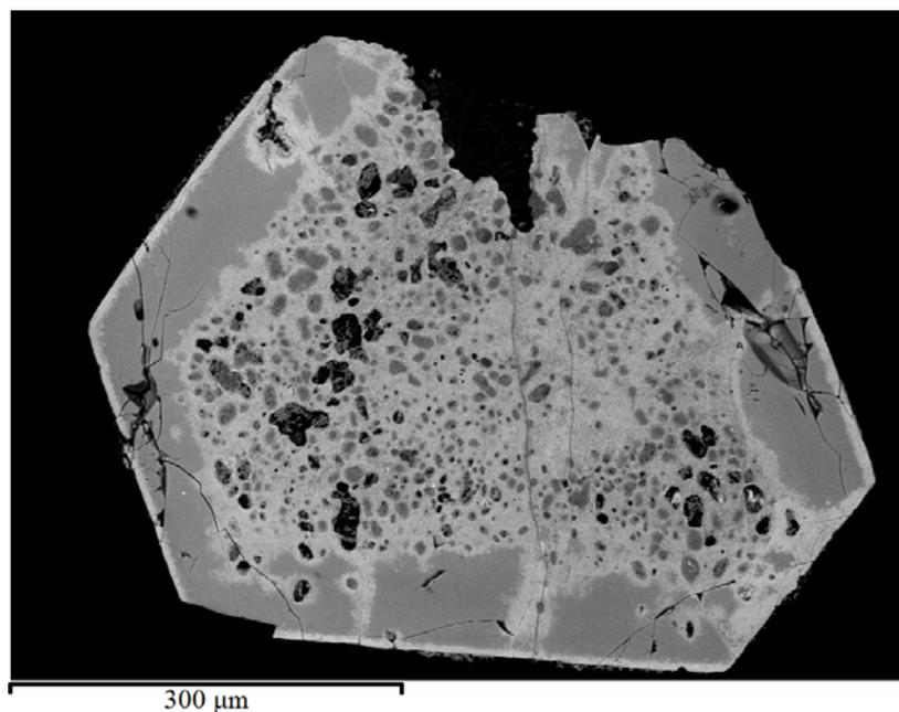
Рисунок 8 – Кристалл пирохлора из пегматоидного гранита СВ части Малого выхода. Краевая каёмка и основная часть кристалла – пирохлор со значительным содержанием свинца (белое) (таблица 7, анализ 1), полоса – безсвинцовый пирохлор (серое) (таблица 7, анализы 2-4). Микровключения флюорита (чёрное). BEI
