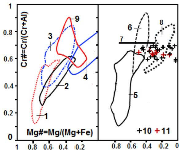
Рисунок 7 – Диаграмма соотношений  $\text{Cr}\# - \text{Mg}\#$  в хромшпинелидах из различных геодинамических обстановок.
