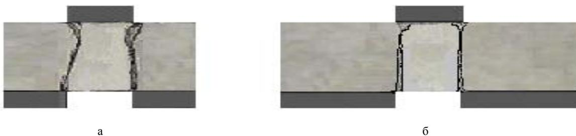
Рисунок 1 – Разрушение бетонной балки путем среза (а) и отрыва (б)
