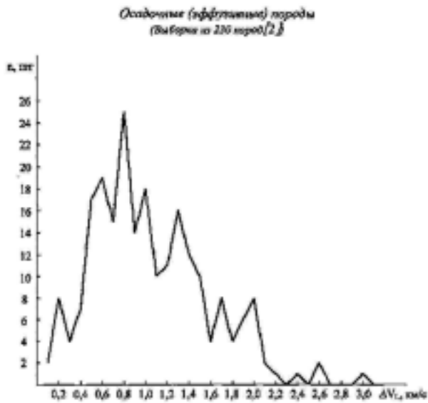
Рис. 2. Гистограмма изменения скорости продольных волн для осадочных пород при давлении 10 000 кгс
