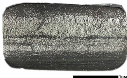
Рисунок 6 – Рудные сульфидные слои в конкреции. Макросъемка аншлифа
