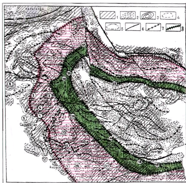
Рисунок 5 - Схема остаточных аномалий силы тяжести Жонгаро-Балхашской складчатой системы (по Г.Р. Бекжанову, 1984)
